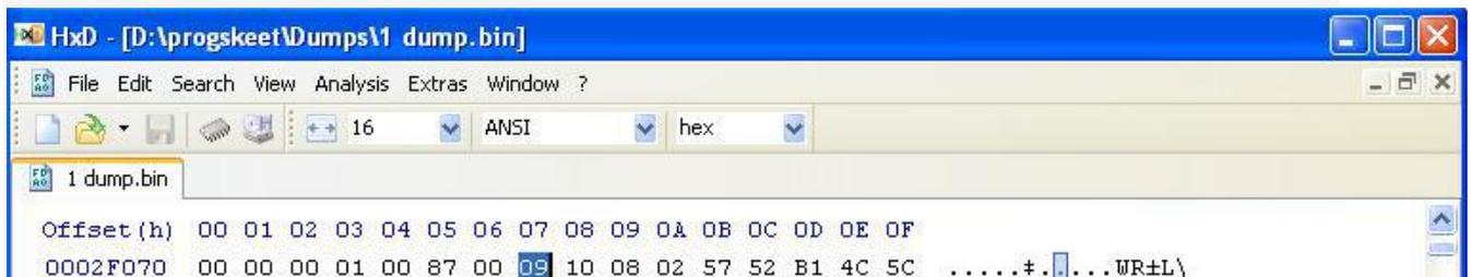
12 IDPS/TARGET ID est à l'offset 0002F077 (faite dérouler jusqu'à l'offset 0002F070 la plus haute rangée est votre dernier chiffre)
